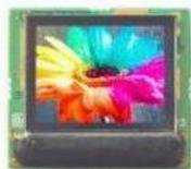
Glazz использует OLED матрицы eMagin, поэтому у него нет таких проблем с изображением. Hololens 1 и Hololens 2 не могут использовать OLED матрицы, так как дифракционные волноводы требуют однонаправленный свет (у OLED матриц каждый пиксель излучает свет веером).
